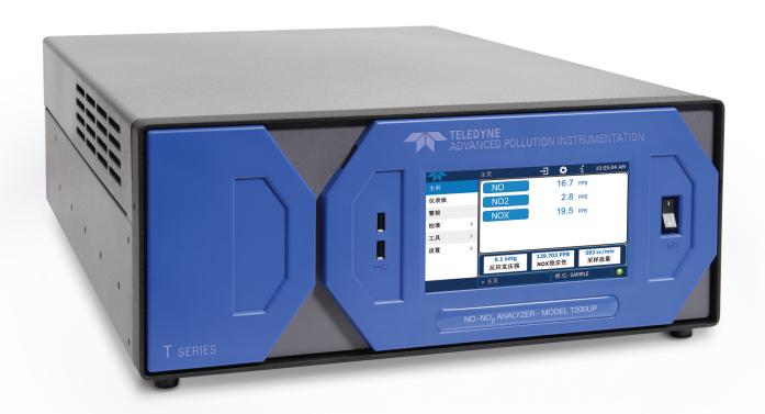
T200UP由我们的T200U型NO $_x$ 分析仪与有专利的 (发明专利,ZL200380105162.1) 高效蓝光转化器 (光解转化器) 组成,用于痕量级NO/NO $_z$ /NO $_x$ 测量。蓝光转化器能够提供效率接近钼转化器的二氧化氮特定转化。\*
