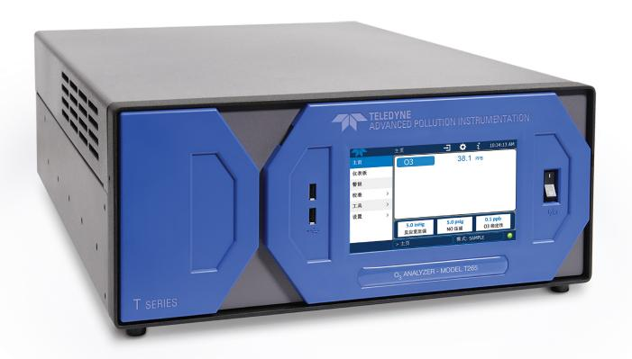
作为商业可用的美国EPA联邦参比法臭氧痕量级分析仪, T265建立在臭氧与一氧化氮结合的化学发光法上。 它可以理想地应用在光度测定法可能有虚假的正面误差(由汞、萜烯、微小悬浮物、 CIO<sub>2</sub> 和挥发性有机化合物造成)的测量当中。
